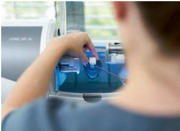
Danach wird die am Computer erstellte Restauration maschinell aus einem Keramikblock ausgeschliffen.
